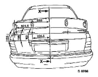
Die Richtigkeit der übertragenen Maße durch Vergleichskontrolle mit dem Spoiler überprüfen und ggfs. korrigieren. Bohrpunkte leicht ankörnen und mit  $\phi$  3 bis 4 mm vorbohren und anschließend auf  $\phi$  8 mm aufbohren.
