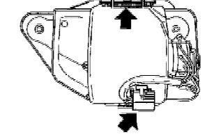
Beide Schrauben herausschrauben und Motor mit Gebläserad aus Wanne entfernen.
